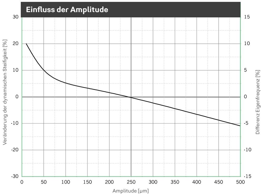
Veränderung der Steifigkeit aufgrund geänderter Amplitude. Mittelwert für 5 Hz, 10 Hz und 40 Hz Anregung. Sinusförmige Anregung bei konstanter Mittellast von 0,011 N/mm<sup>2</sup>, Probenabmessung 300 x 300 x 25 mm. Eigenfrequenz für einen eindimensionalen Feder-Masse-Schwinger auf starrem Untergrund.
