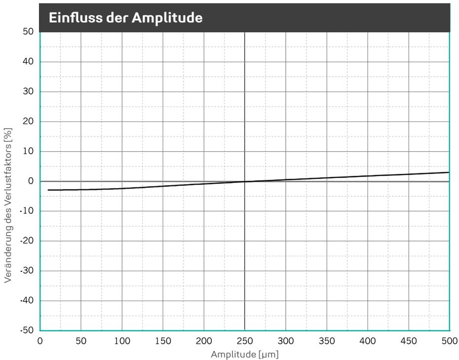
Veränderung des Verlustfaktors aufgrund geänderter Anregeamplitude. Sinusförmige Anregung bei konstanter Mittellast von 0,450 N/mm<sup>2</sup>, Probenabmessung 300 x 300 x 25 mm.
