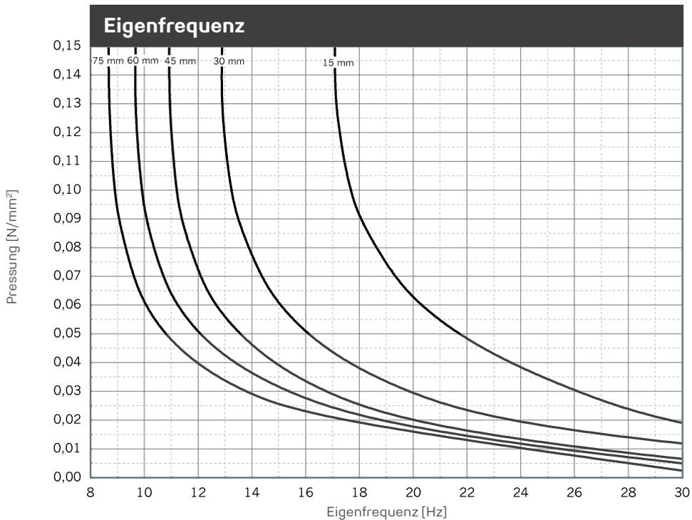
Eigenfrequenzverläufe für einen eindimensionalen Feder-Masse-Schwinger unter Berücksichtigung der dynamischen Steifigkeit von **REGUPOL vibration 480** auf starrem Untergrund. Probenabmessung 300 mm x 300 mm.
