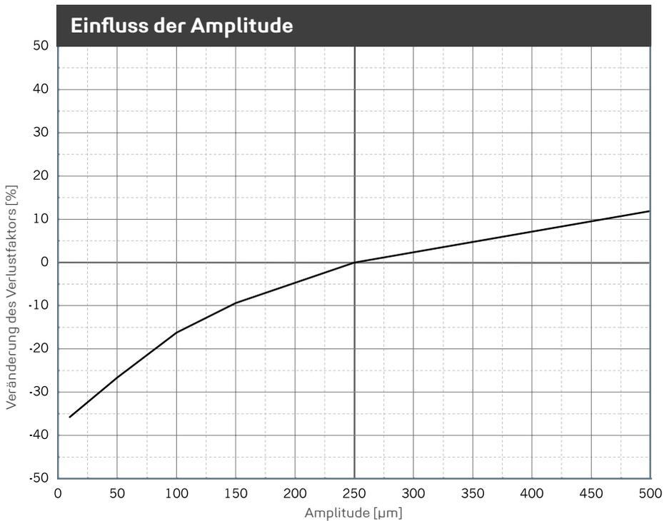
Veränderung des Verlustfaktors aufgrund geänderter Amplitude. Sinusförmige Anregung bei konstanter Mittellast von 0,10 N/mm<sup>2</sup>, Probenabmessung 300 x 300 x 60 mm.
