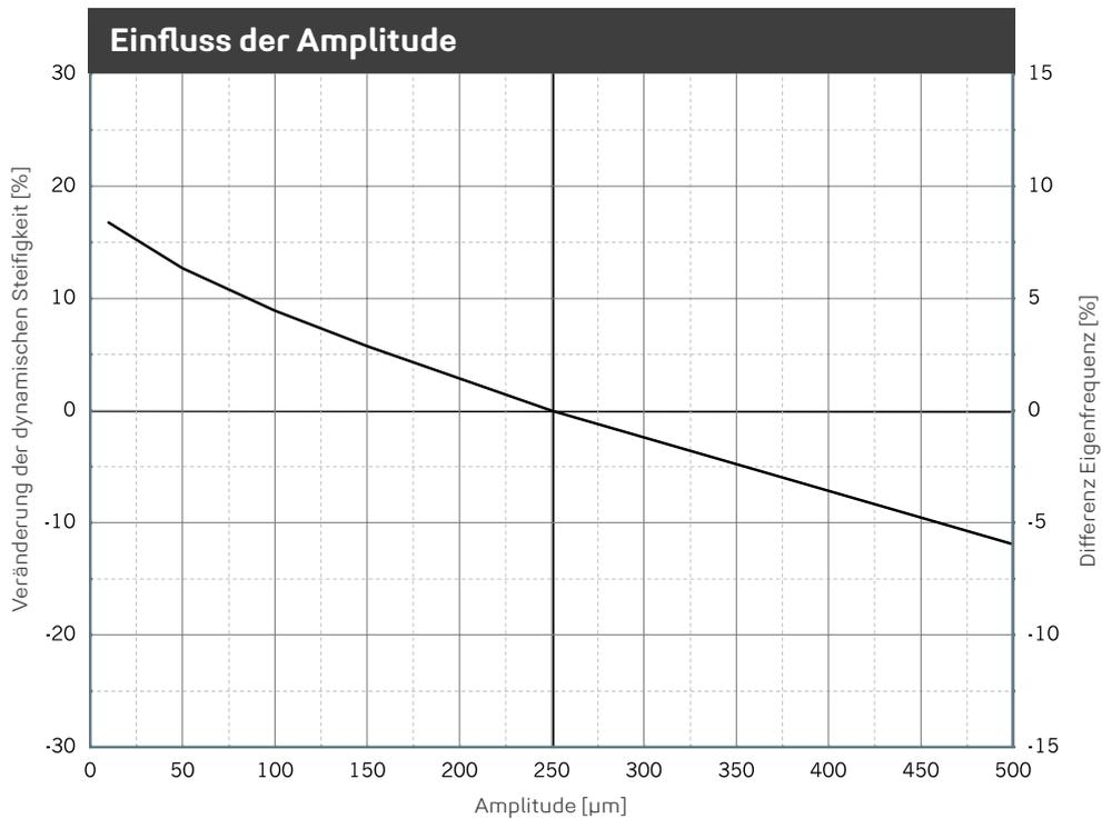
Veränderung der Steifigkeit aufgrund geänderter Amplitude. Mittelwert für 5 Hz, 10 Hz und 40 Hz Anregung. Sinusförmige Anregung bei konstanter Mittellast von 0,10 N/mm<sup>2</sup>, Probenabmessung 300 x 300 x 60 mm. Eigenfrequenz für einen eindimensionalen Feder-Masse-Schwinger auf starrem Untergrund.
