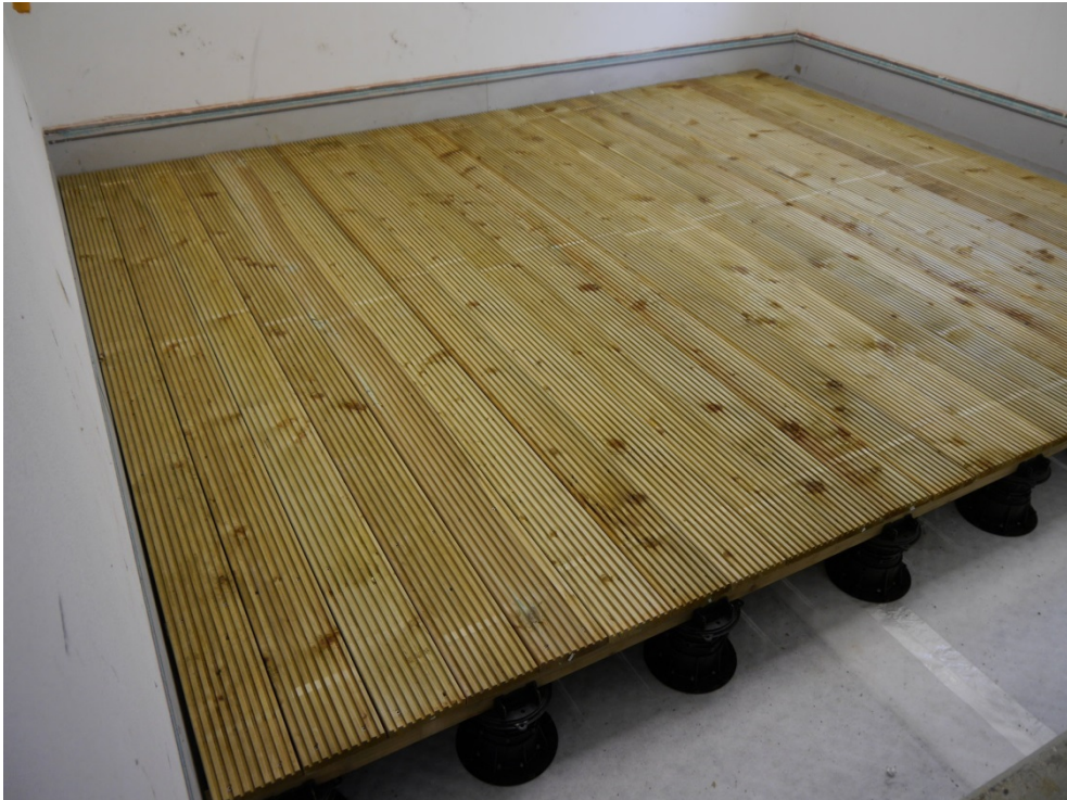
Abbildung B.5. Prüfaufbau im Deckenprüfstand: prüffertig.
